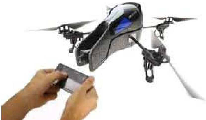
Parrot a lancé le produit AR.Drone 2.0 avec caméra HD 720P et Wifi N en janvier 2012. Il dispose de la fonction "flip", ainsi que des améliorations concernant la stabilité et le design. Il possède désormais un baromètre et un magnétomètre.
