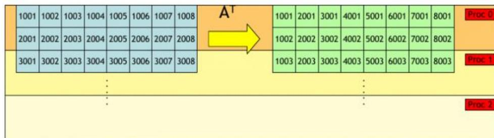
Résoudre le problème distribuant A et B par lignes (ou colonnes) sur les tâches en utilisant la communication collective MPI\_ALLtoALL. Noter que cette fonction collective fonctionne avec des données stockées dans la mémoire contiguë donc choisir avec soin comment il faut stocker la matrice par lignes ou colonnes.
