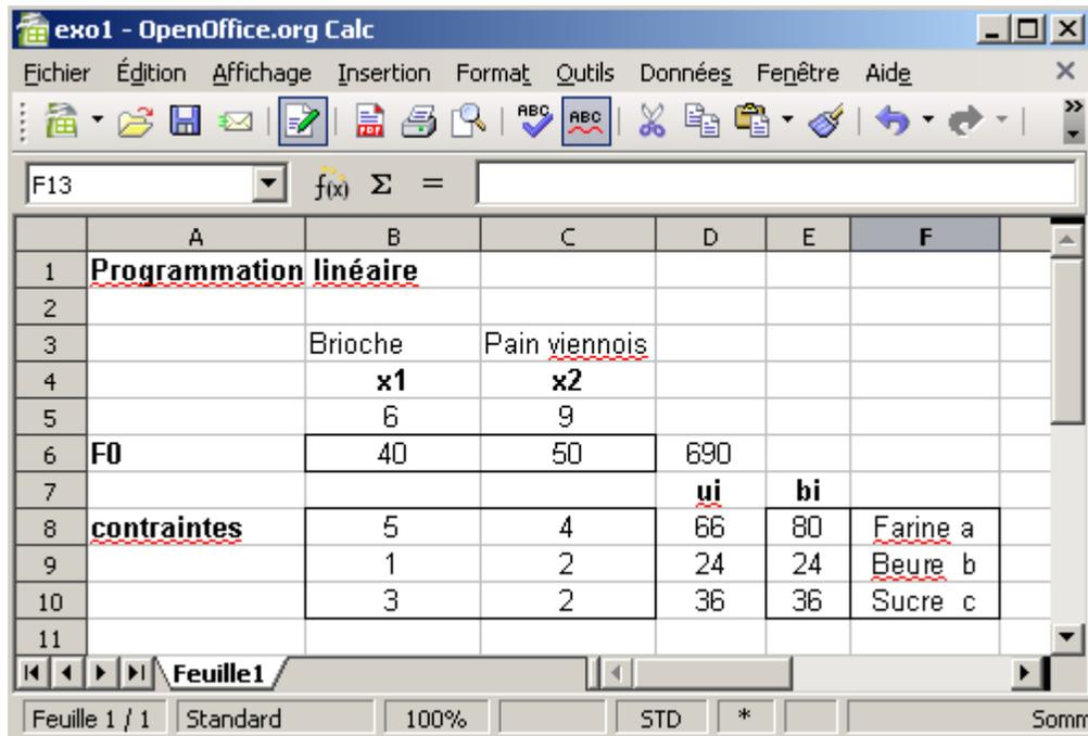
3. En utilisant la fonction *linpro* de SCILAB, résoudre le problème de notre boulanger.
