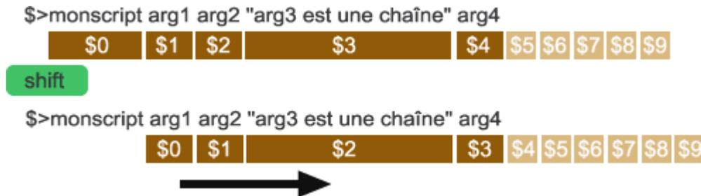
*Mécanisme du shift*
